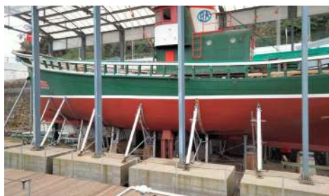
Forro de babor restaurado
